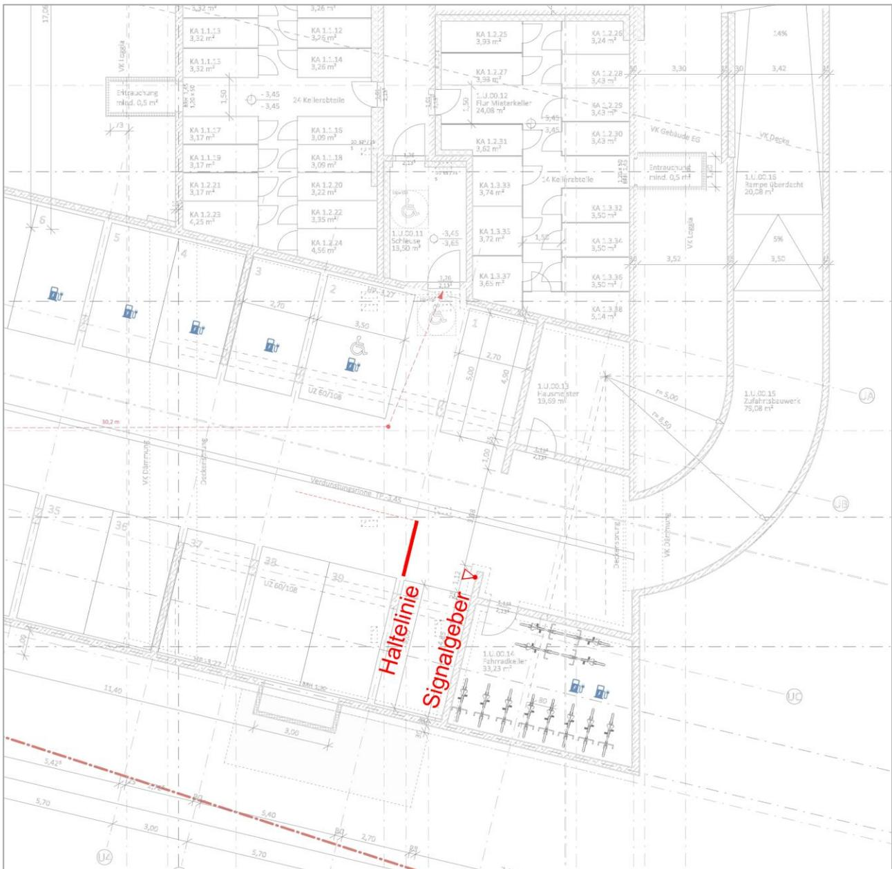
Abbildung 8: Grundriss Tiefgarage mit beispielhaft eingezeichneter Haltelinie und Signalgeber
