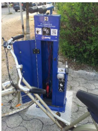
Reparaturstation (Gemeinde Planegg)
